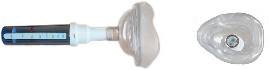
Met een Peak Nasal Inspiratory Flow (PNIF) meter kun je de maximale inademing door de neus meten. Links: Zijaanzicht. Rechts: Boven aanzicht. (Foto: WKRU)
